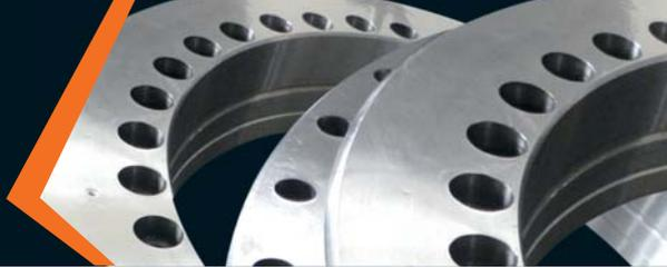
YRTS 高速系列转台轴承，外形结构尺寸同于 YRT 标准系列转台轴承，但其特殊的内部结构设计使其具有更高的极限转速，并且在整个转速范围内的摩擦力较低并且均匀。因而适合类似于 YRT 标准系列应用但需要较低摩擦和高转速的场合，例如直接驱动轴的轴承应用，尤其适合于数控转台结构中轴承的选用，例上页图 2。
